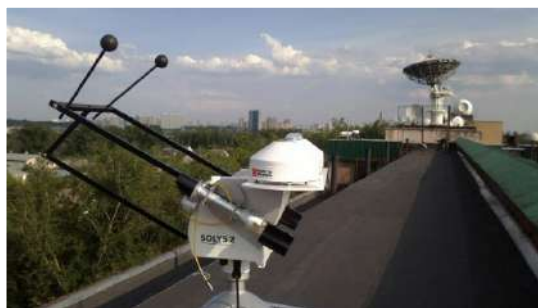
Актинометрический комплекс производства Kipp & ZONEN
