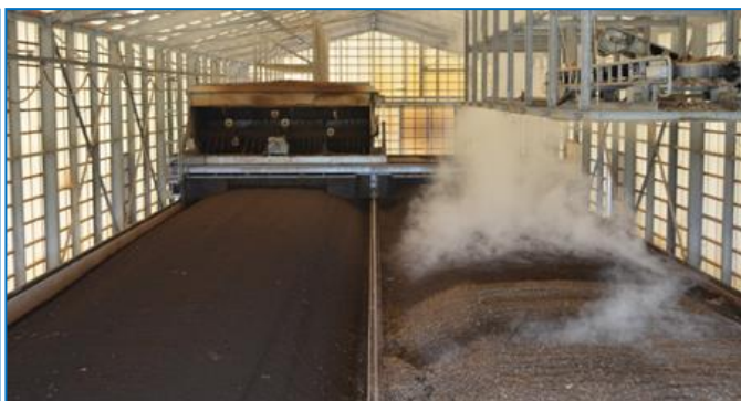
Каждый компостер обслуживает две траншеи. Система вентиляции отводит излишки тепла из пометной кучи
