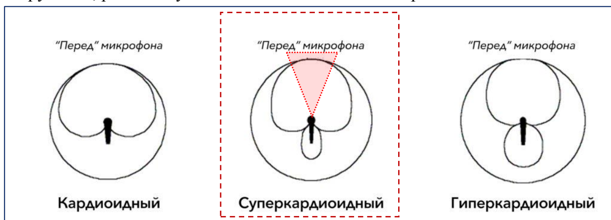
Рисунок 3. Схемы однонаправленных стационарных (проводных) микрофонов — кардиоидный, суперкардиоидный, гиперкардиоидный. В медицинских учреждениях МО используются суперкардиоидные микрофоны.
